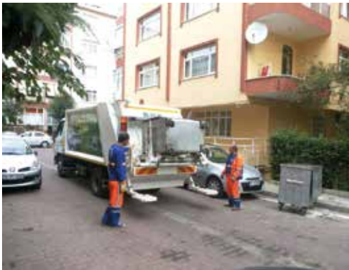
Sıkıştırırmalı Araç İle Çöp Toplama Sistemi
